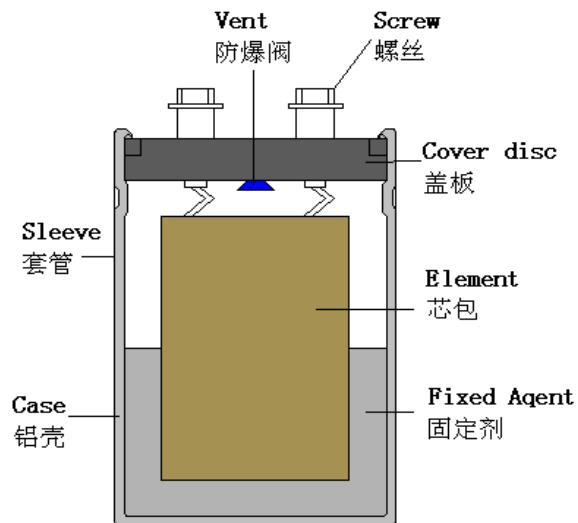
7-2 工艺芯包分解图 (Element drawing)
